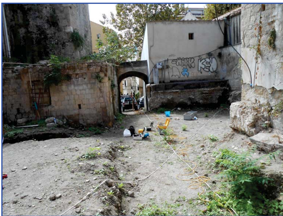
Prospezione sismica MASW effettuata.
